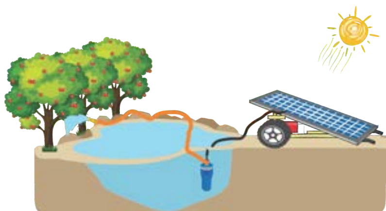
Bomba pressurizada de 12VDC, de 3.5 GPM, em torno de 700 litros/h
